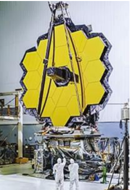
مونتاژ آینه تلسکوپ فضایی جیمز وب. آینه این تلسکوپ، یک آینه مرکب است که با طلا پوشیده شده است تا منعکس کننده نور مرئی (نارنجی - قرمز) نزدیک به فروسرخ باشد
