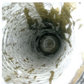
ایجاد سوراخی به عمق ۱۲ فوت در دولومیت توسط دستگاه لیزری ساخت شرکت Foro Energy
